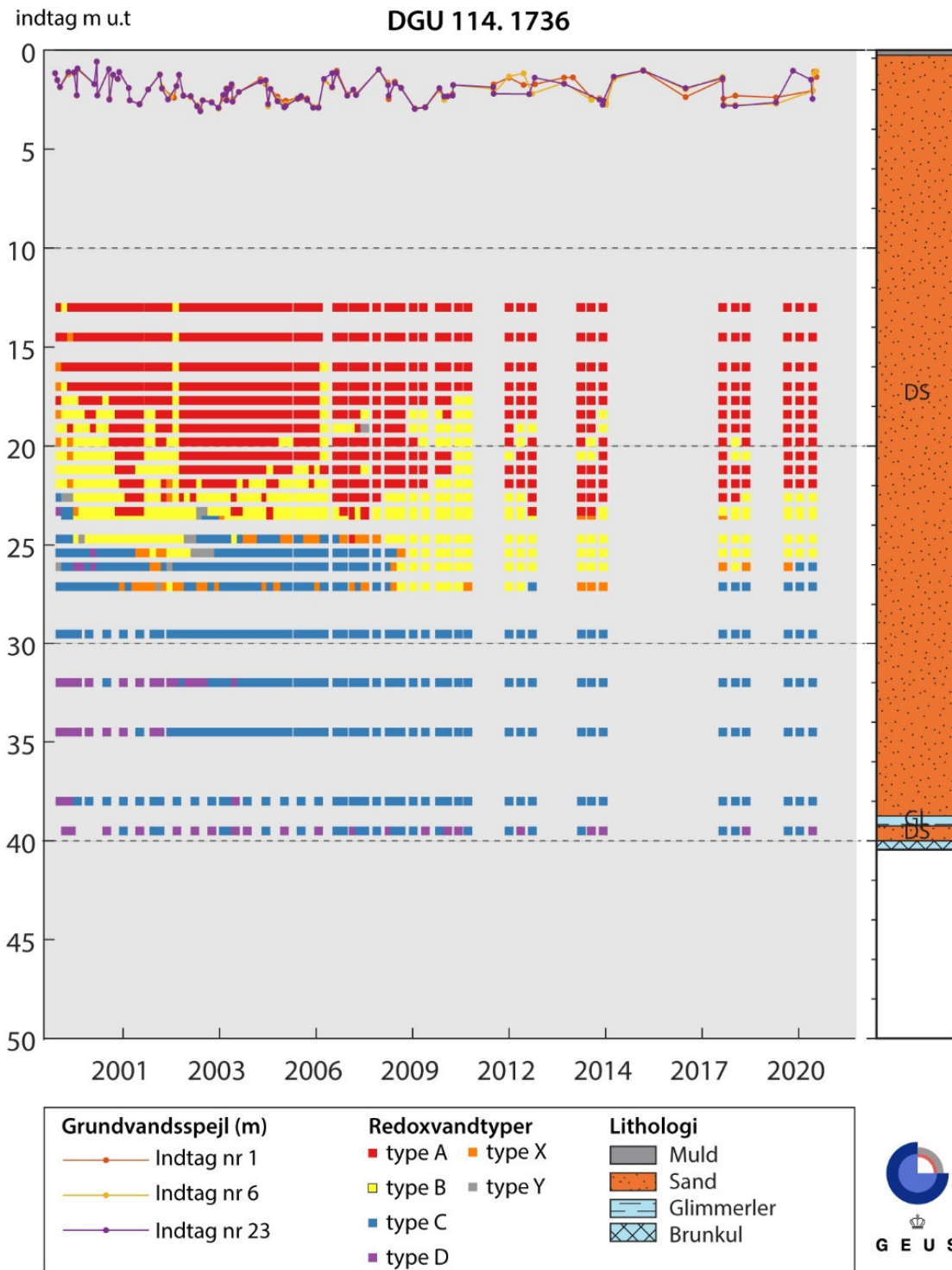
Figur 35. Grindsted i Midtjylland, DGU nr. 114.1736 med redoxvandtyper for perioden 1999-2020. Grundvandsspejlet er beliggende i ca. 2 m u.t. Det geologiske profil er vist længst til højre på figuren.
